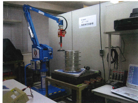
図3 重い分銅を正確な位置にセットする装置
